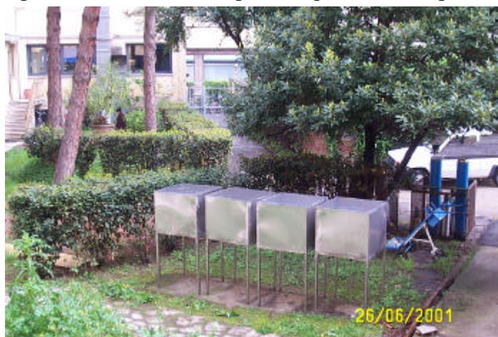
Fig. 3 - Sistema di raccolta del fall-out
