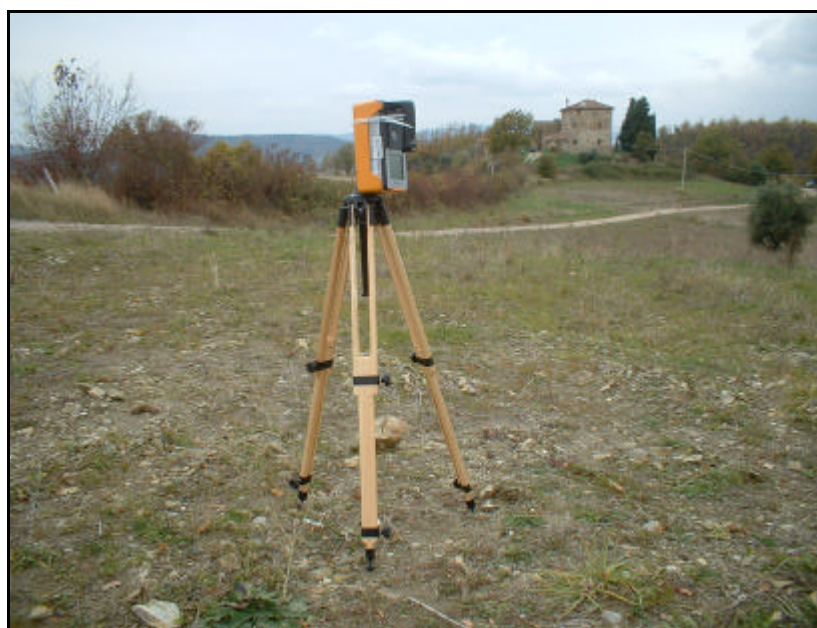
Fig. 5 - Misura del rateo di dose gamma all'aperto – Diacceto (FI)
