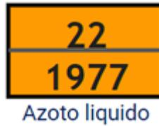
Figura 1 – Numeri ADR per il trasporto di azoto liquido
