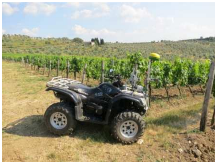
Fig. 7 – Strumentazione mobile per effettuare il rilievo prossimale di NDVI.
