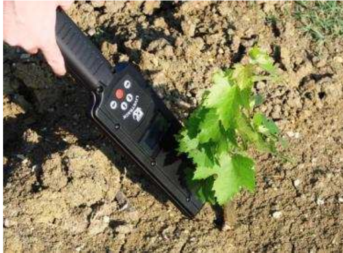
Fig. 4 – Reader per la lettura delle informazioni dal microchip.
