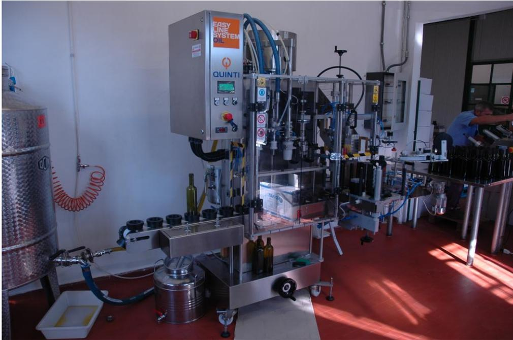
Il flusso di olio viene indirizzato al centro della bottiglia senza creare come normalmente avviene, un velo sulla parete interna. Il contatto con l'aria viene quindi minimizzato e la velocità di riempimento è superiore ai sistemi attualmente in commercio
