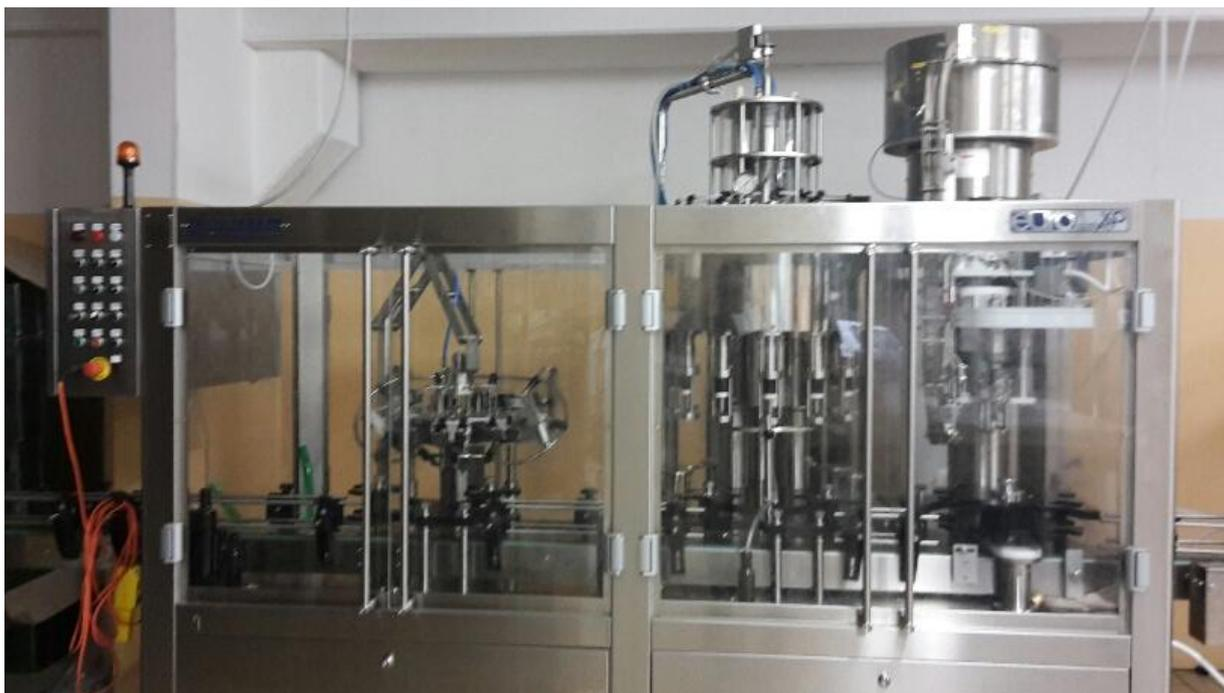
La macchina è realizzata con accorgimenti che consentono di ridurre l'esposizione dell'olio imbottigliato all'ossigeno al minimo. La protezione dell'olio durante tutto il ciclo di imbottigliamento avviene mediante azoto.
