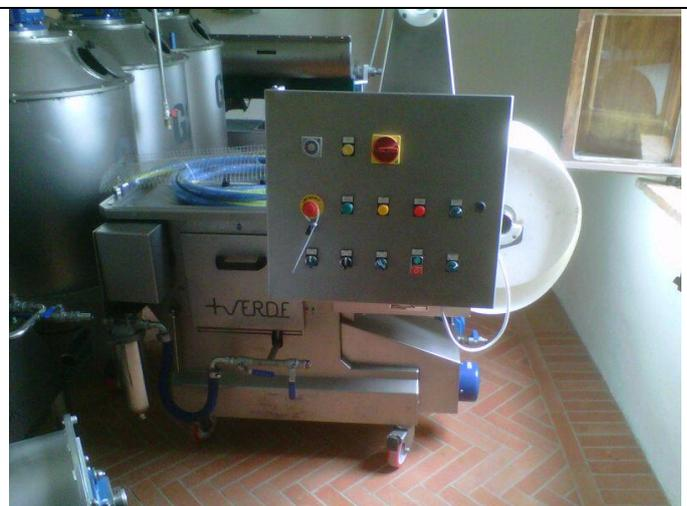
Il prototipo messo in funzione è costituito da un pacco filtrante con pressione idraulica e da un sistema di trascinamento dei rotoli di carta a velocità variabile, il tutto è preceduto da un pacco di prefiltrazione di cartucce in acciaio inox (50-40-25-20-10-5 micron da 30 pollici). L'olio che fuoriesce dal filtro passa da una cartuccia per eventuale insufflaggio di gas inerte. L'olio arriva alla vaschetta situata all'uscita del decanter, questo viene aspirato dalla pompa dei filtri
