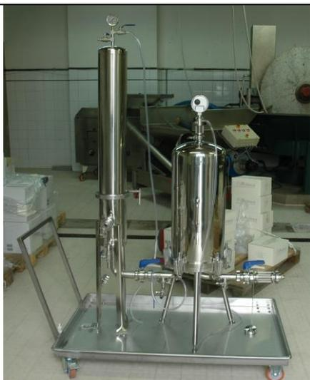
Il prototipo del sistema filtrante realizzato da Bagnoli ha un prefiltro con campana munita di cartucce inox ad alta superficie relativa e una campana munita di filtro lenticolare. Entrambe le campane hanno vari sistemi e modi di utilizzare l'inertizzazione e una serie di valvole capaci di bypassare uno o l'altro filtro, secondo le necessità. Inoltre, il sistema di bypass permette di lavorare in linea o in parallelo.
