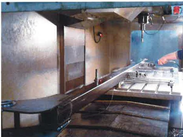
Assemblaggio di bracci con le attività di saldatura lavorazione meccanica e relativa calibrazione
