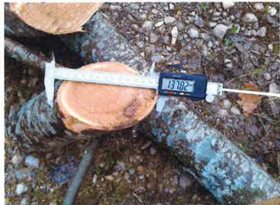
Alcuni rami di potatura dei castagni tagliati con la macchina durante le prove riuscendo a lavorare tranquillamente anche su diametri di circa 15 cm ( la misura riportata nella foto si riferisce a millimetri)
