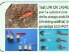
Test UNI EN 14045 per la valutazione della compostabilità (biodegradabilità) dei prototipi ECO-POT
