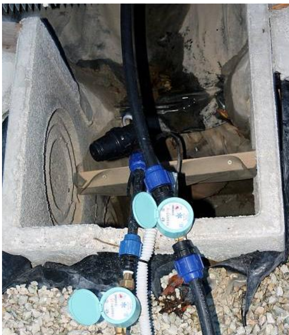
Particolari del lisimetri costruiti per per il collaudo dei consumi idrici calcolati dai sensori SMS. A sinistra pozzetto di raccolta del drenato di una intera fila di piante: si noti la pompa di sentina, i contatori elettronici per la misura della quantità di acqua distribuita e di quella drenata, raccolta dalla trincea con il grigliato. A sinistra sede del vaso, con rete anti-corpi estranei e naylon atto ad evitare l'evaporazione dalla trincea.
