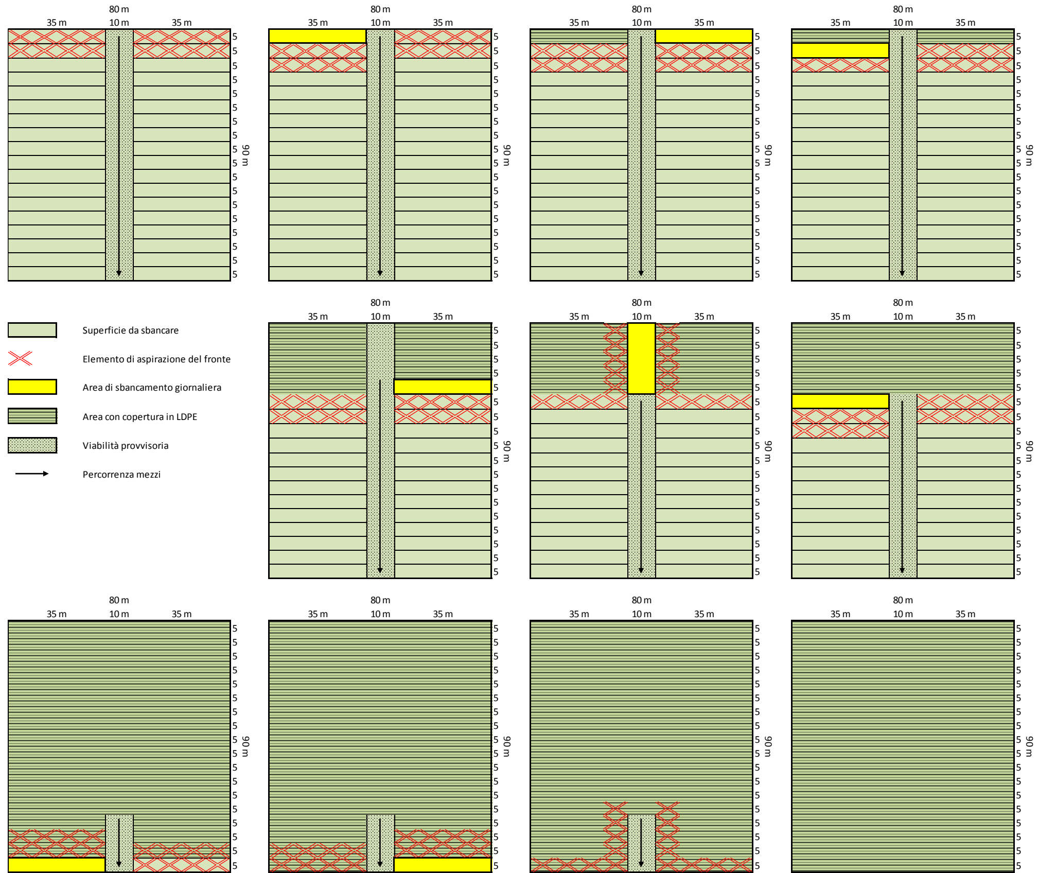
Figura 3:6 - Schema grafico descrittivo delle operazioni di sbancamento
